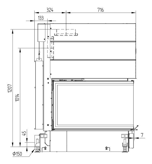
**GRUNDMASSEN + FÜSSE + ZULUFTANSCHLUSS**
